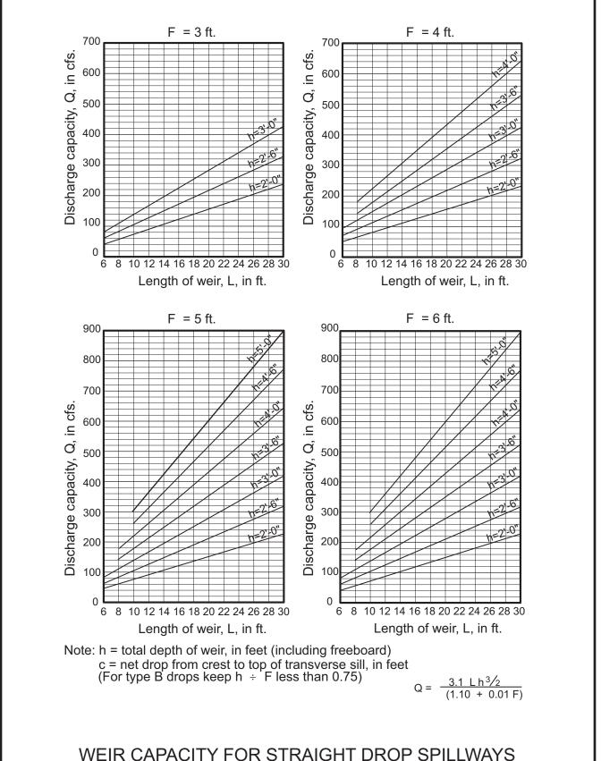
WEIR CAPACITY FOR STRAIGHT DROP SPILLWAYS
